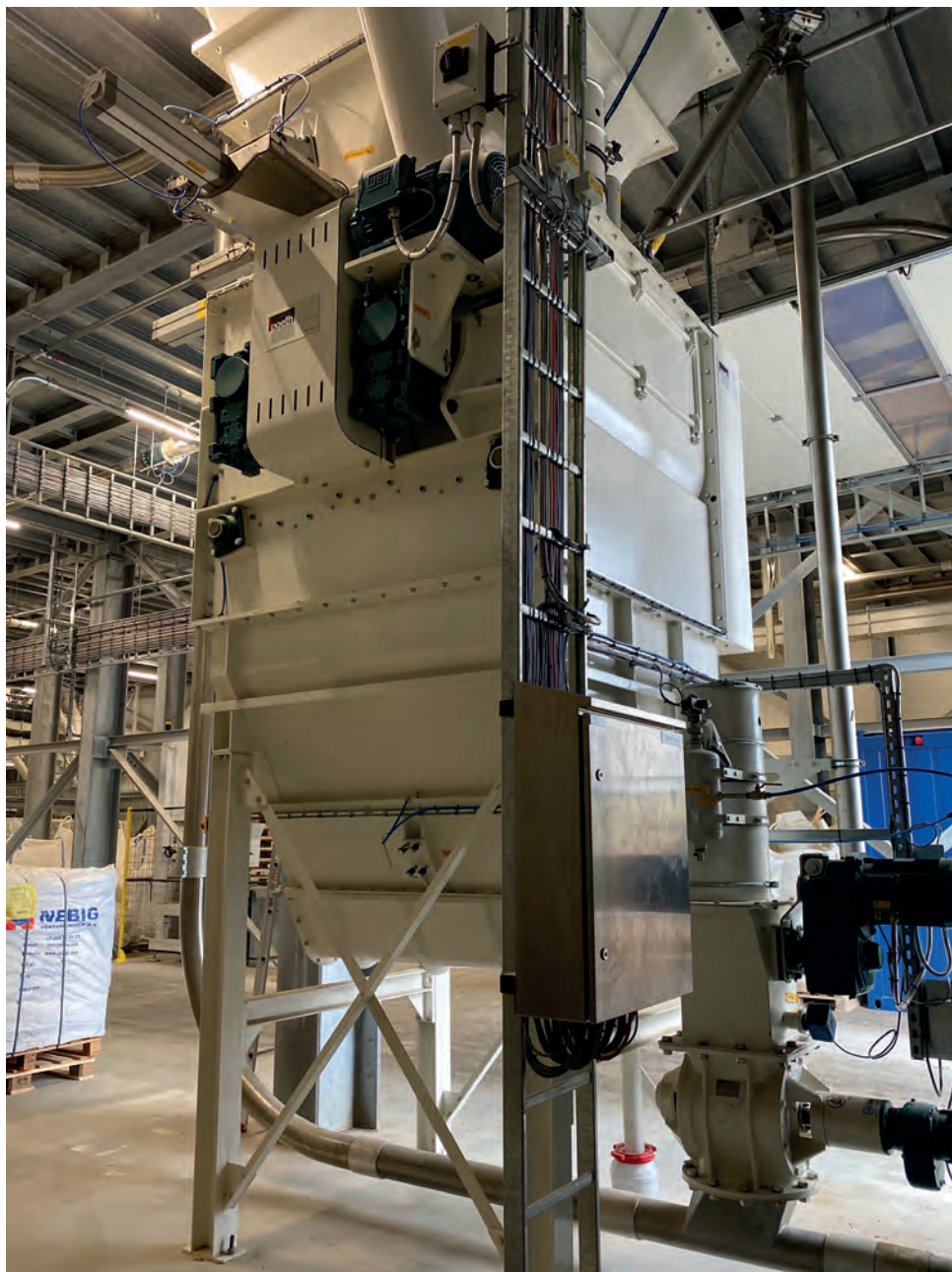
Afb. 1 De Poeth menglijn met dubbelassige peddelmenger.
